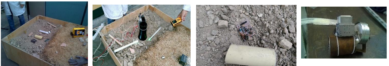
Fig. 9. a. Maqueta del terreno. b. antena en terreno. c. Circuito incinerado. d. Prototipo antena
